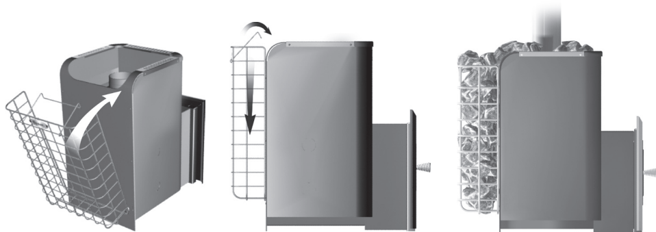
Рисунок- 10. Установка сетки-каменки на печь.
