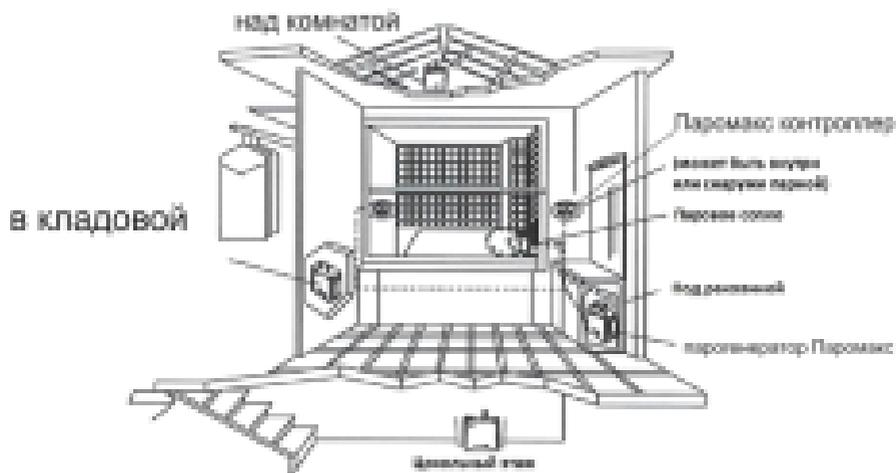
Для крепления парогенератора к стене, на задней крышке имеются три отверстия. Вначале устанавливаются два верхних дюбеля крепления, и парогенератор закрепляется на них по уровню, затем крепится на нижний третий дюбель.
