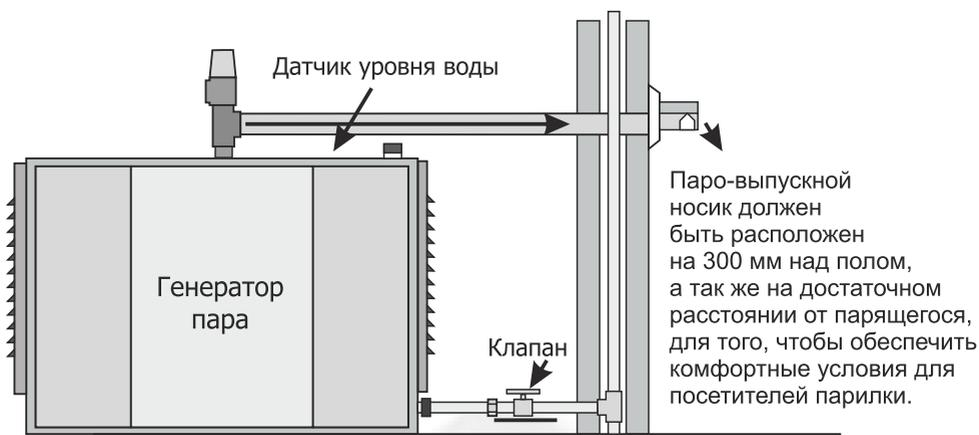
Для отвода пара необходимо подсоединить медную трубку соответствующего диаметра (15 мм - для парогенераторов 4-6 кВт, или 22 мм - для парогенераторов 9-18 кВт) с теплоизоляцией к отверстию верхнего тройника с надписью «Выход пара». Другой конец трубки заводится в парную и на него устанавливается специальная форсунка.
